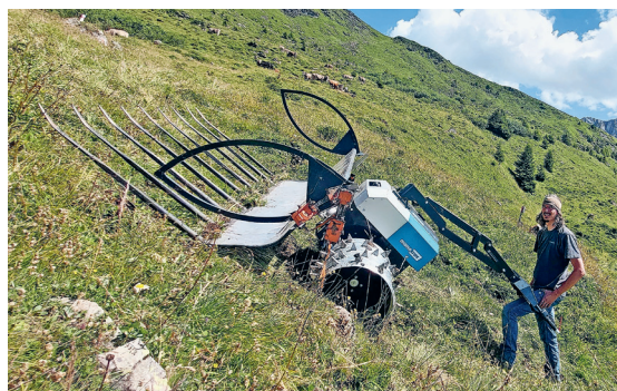
Der Prototyp eines Elektro-Motormähers als Pilotprojekt, im Einsatz am Eggberg.
